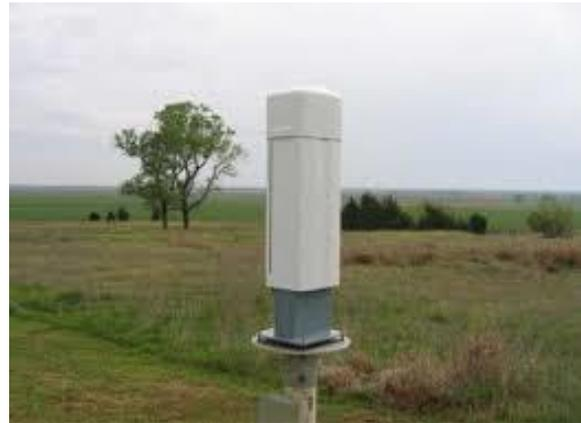
Ceilometer memancarkan sinar laser ke atas atmosfer dan kemudian mengukur waktu yang dibutuhkan sinar laser untuk kembali ke alat. Dari waktu tersebut, dapat dihitung ketinggian awan di atas permukaan tanah.
